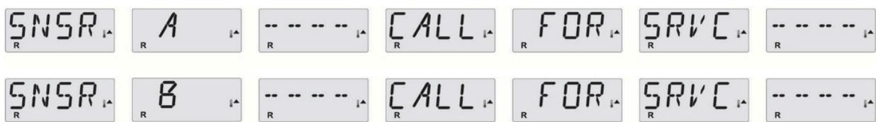
Un capteur de température ou un circuit de capteur est défectueux. **Contactez le support technique.**
